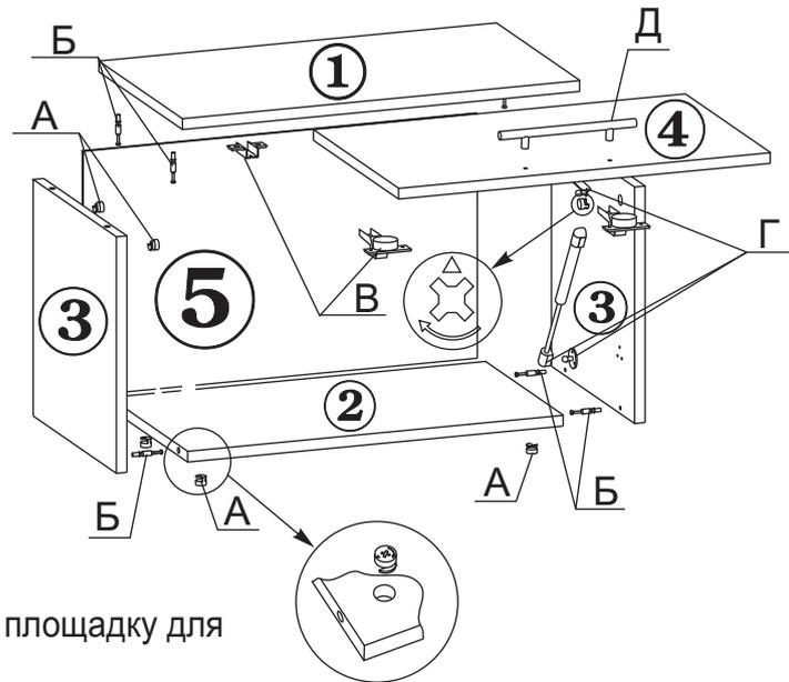
1. Закрепите на одной из боковин (дет.№3) крепежную площадку для крепления газового лифта.
