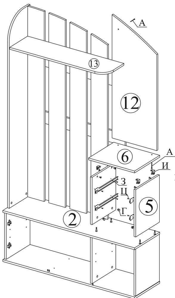
1.3. Прикрутите шурупами 3,5x16 роликовые направляющие к дет.№№5. В пластиковые муфты наживите винты М6x12. К дет.№6 прикрутите винтами М6x12 угловую стяжку неразъемной стороной. Соедините дет.№№5 с дет.№2. Для этого штоки эксцентриков должны попасть в отверстия на торце дет.№5. Поверните эксцентрики на 180 градусов по часовой стрелке. Опустите дет.№6 так, чтобы прорезы на угловой стяжке попали в винты на дет.№№5. Закрутите винты. С помощью винтовой стяжки прикрепите дет.№12 к дет.№№6,13.
