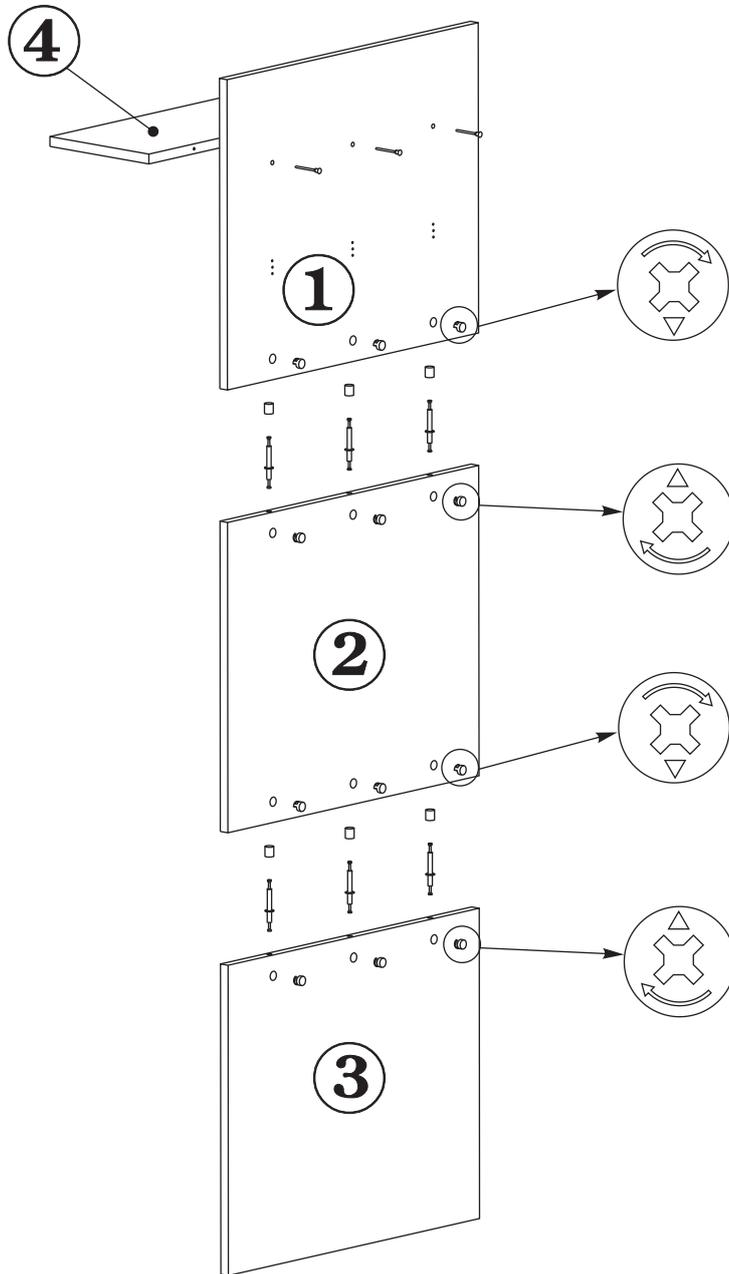
1. В отверстия на вертикальных панелях (дет.№№1,2,3) вставьте эксцентрики. Обратите внимание: стрелка на эксцентрике должна быть направлена к торцу детали.
