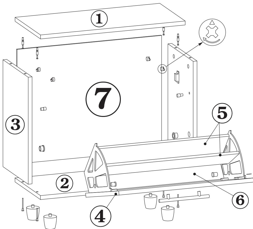
1. В отверстия на боковинах (дет.№3) вставьте втулки кронштейнов, ограничили и эксцентрики. Обратите внимание: стрелка на эксцентрике должна быть направлена к верхнему торцу детали. Шурупами 3x20 закрепите на правой боковине магнитную защелку.
