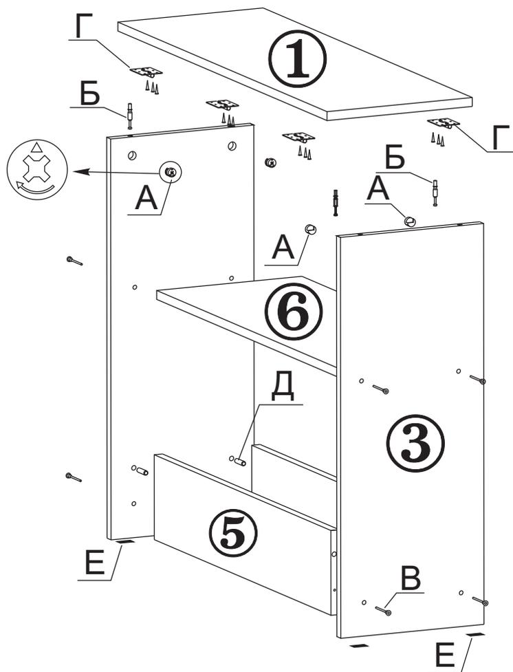
1.1. В отверстия на столешнице (дет.№1) закрутите штоки эксцентриков (поз.Б), шурупами 3,5x16 закрепите картонные петли (поз.Г).
