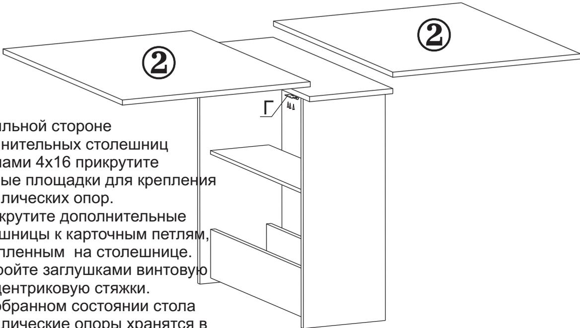
1.3. К тыльной стороне дополнительных столешниц шурупами 4x16 прикрутите опорные площадки для крепления металлических опор.
