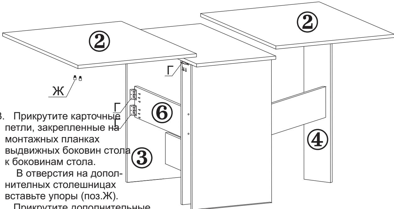
1.3. Прикрутите карточные петли, закрепленные на монтажных планках выдвижных боковин стола к боковинам стола.
